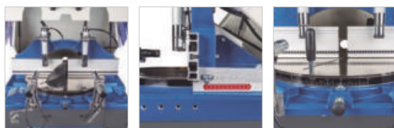
ULMS 420 con accesorios transportador de rodillos con tope longitudinal y medición manual con escala en mm (opcional).
